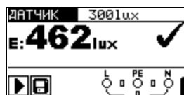
Рисунок 5.58: Пример результата измерения освещенности
