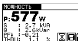
Рисунок 5.47: Результаты измерения мощности
