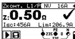
Рисунок 5.28: Примеры результатов измерения импеданса контура
