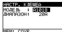
Рисунок 4.12: Настройка конфигурации измерительного входа токоизмерительных клещей
