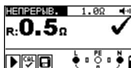
Рисунок 5.15: Пример непрерывного измерения сопротивления
