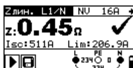
Рисунок 5.32: Примеры результатов измерения импеданса линии
