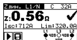
Рисунок 5.32: Примеры результатов измерения импеданса линии
