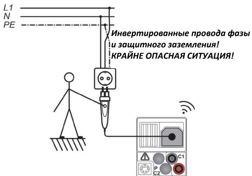
Рисунок С.4: Инвертированные проводники L и PE (применение щупа «plug commander»)
