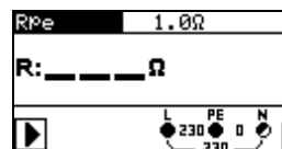
Рисунок 5.53: Сопротивление провода защитного заземления PE
