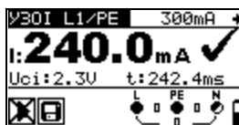
Рисунок 5.23: Пример результата измерения тока отключения
